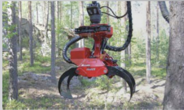
Monipuolisella uutuuskouralla onnistuu tehokkaasti myös puun kuormaaminen. Koura painaa silti vain 330 kg ja keräävänä 380 kg.
