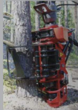
Giljotiinilla katkeaa kätevästi aina 15-20 cm paksuiset puut ja sahalla halkaisijaltaan jopa 45 cm puut.
