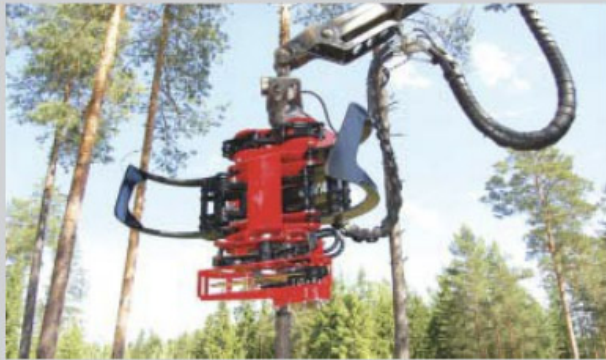
Uudessa Mecanil XG 220 energiapuukourassa on sekä saha- että giljootinikatkaistu.
